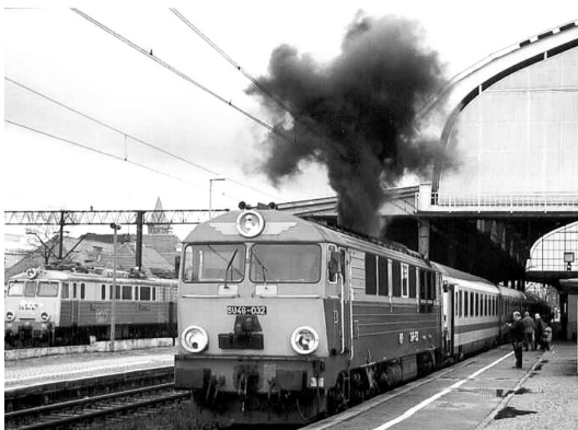
Rys. 3. Zanieczyszczenie atmosfery przez przestarzałe rozwiązania spalinowych pojazdów trakcyjnych [fot. A. Massel]
