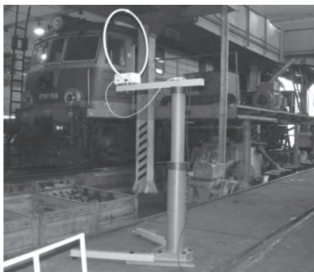
Rys. 3. Aktywna antena pętlowa typu EMCO 6502 podczas pomiarów w hali lokomotywowni [fot. Ł. John]
