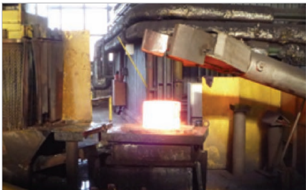
Rys. 2. Wygrzany materiał po usunięciu zgorzeliny z powierzchni [fot. autor]
