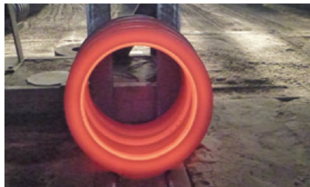
Rys. 4. Studzenie obręczy po walcowaniu w stojakach w hali produkcyjnej
