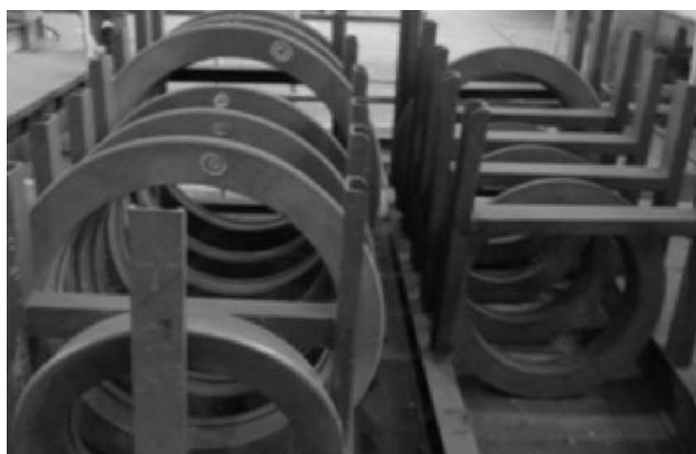
Rys. 7. Próbkę odniesienia obręczy do badań ultradźwiękowych [fot. autor]
