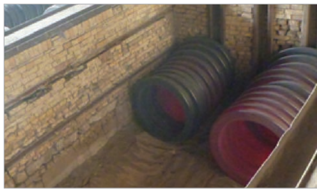
Rys. 5. Studzenie obręczy po walcowaniu w dole chłodniczym [fot. autor]
