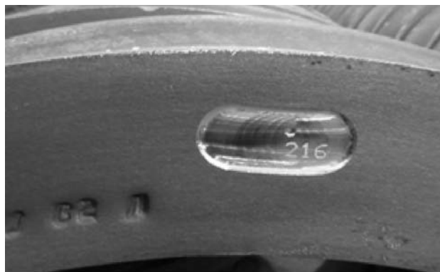
Rys. 8. Sprawdzenie twardości obręczy [fot. autor]
