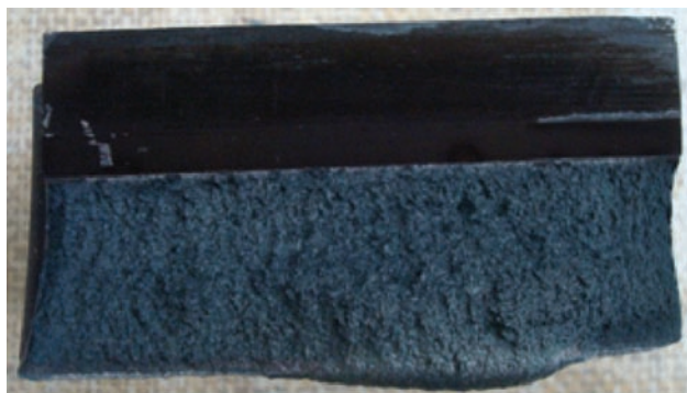
Rys. 11. Przelom na niebiesko obręczy A studzonej w dole [fot. autor]
