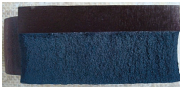
Rys. 12. Przelom na niebiesko obręczy B studzonej w hali produkcyjnej [fot. autor]
