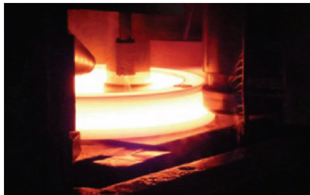
Rys. 3. Proces walcowania obręczy kolejowych [fot. autor]
