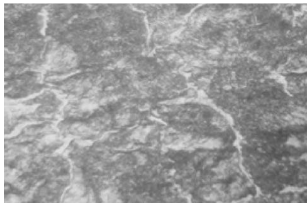
Rys. 13. Mikrostruktura obręczy A po walcowaniu, studzonej w dole [fot. autor]
