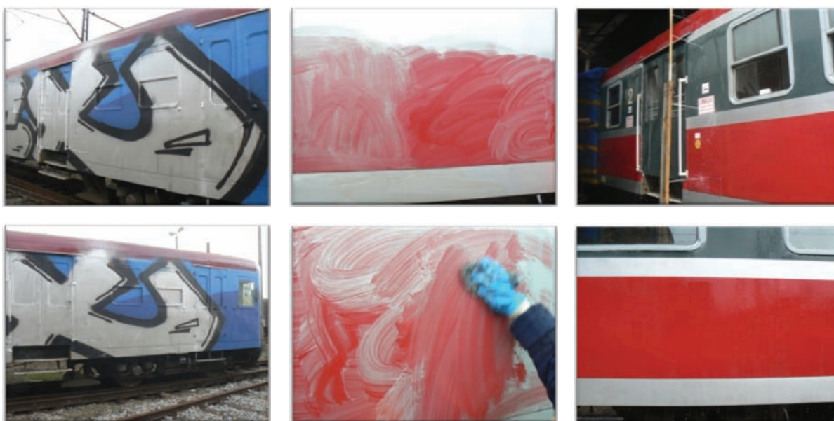
Rys. 4. Proces usuwania graffiti z pojazdu EZT serii EN57 pokrytego farbą BO-100AGR, kwiecień 2015 [fot. autor]
