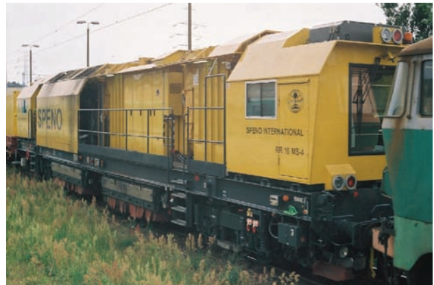
Rys. 7. Pociąg do szlifowania szyn RR 16 MS-4 w składzie pociągu [fot. A. Etmanowicz]
