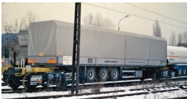
Rys. 6. Specjalistyczna naczepa bimodalna przewożona na wózkach kolejowych [fot. A. Etmanowicz]
