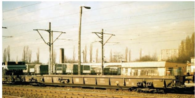
Rys. 8. Wagon typu Rollende Landstraße serii Saadkms 690 o obniżonej podłodze i zestawach kołowych o średnicy 360 mm do przewozu samochodów ciężarowych [fot. A. Etmanowicz]
