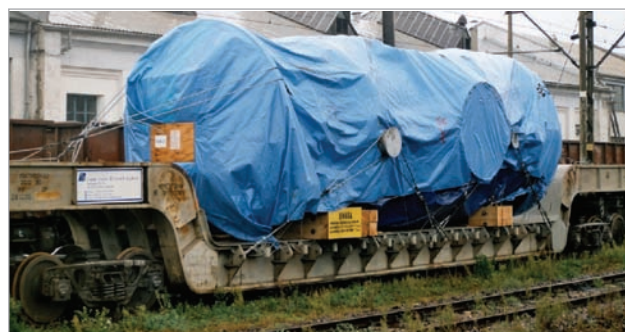
Rys. 2. Wagon 16-osiowy kolei ukraińskich (UZ) z zagłębioną podłogą załadowany generatorem [fot. A. Etmanowicz]
