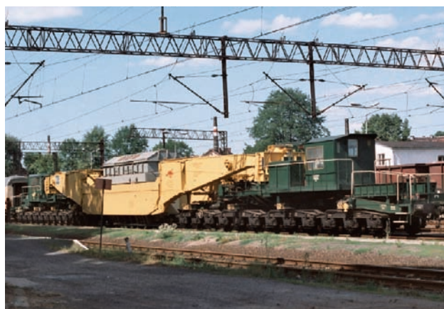
Rys. 10. Ładunek na wagonie 24-osiowym AE [fot. A. Etmanowicz]
