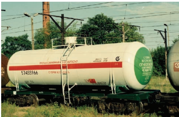
Rys. 5. Cysterna czteroosiowa budowy WNP o przekroczonej skrajni taboru 1-WM, [fot. A. Etmanowicz]
