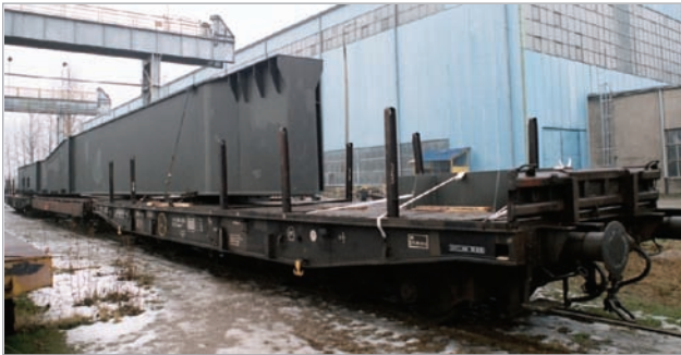
Rys. 3. Belka o masie około 100 ton załadowana na dwa wagony – platformy budowy specjalnej DB serii Samms 709 z ławami pokrętnymi [fot. A. Etmanowicz]
