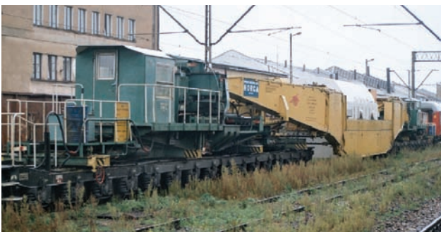
Rys. 4. Wagon 32-osiowy typu „Norca 32” serii Uaai, załadowany transformatorem zamocowanym bezpośrednio do obu części wagonu [fot. A. Etmanowicz]
