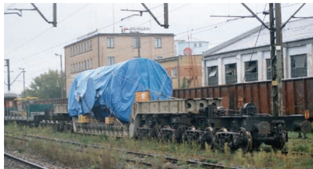
Rys. 9. Ładunek z przekrozoną skrajnią na wagonie 16-osiowym [fot. A. Etmanowicz]
