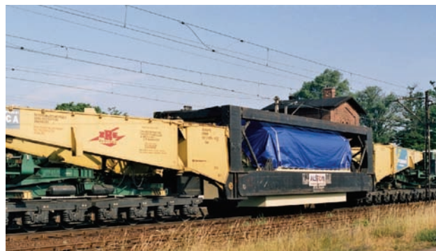
Rys. 1. Wagon 32 osiowy typu „Norca 32” serii Uaai załadowany generatorem umieszczonym w specjalnej klatce między burtami wagonu [fot. A. Etmanowicz]
