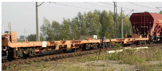
Rys. 21. Platforma dwuczłonowa na czterech wózkach [fot. A. Zbieć]
