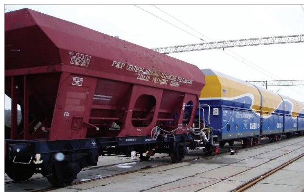
Rys. 19. Czteroczłonowy krótkosprzęgnięty wagon samowyładowczy o członach dwuosiowych [fot. A. Zbieć]
