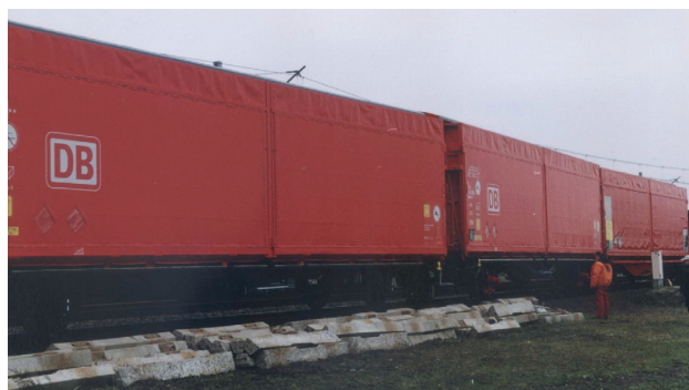
Rys. 20. Wagon dwuosiowy z przesuwными ścianami badany w wariancie uzupełniającym, w którym wagon badany otoczony jest dwoma takimi samymi wagonami [fot. A. Zbieć]
