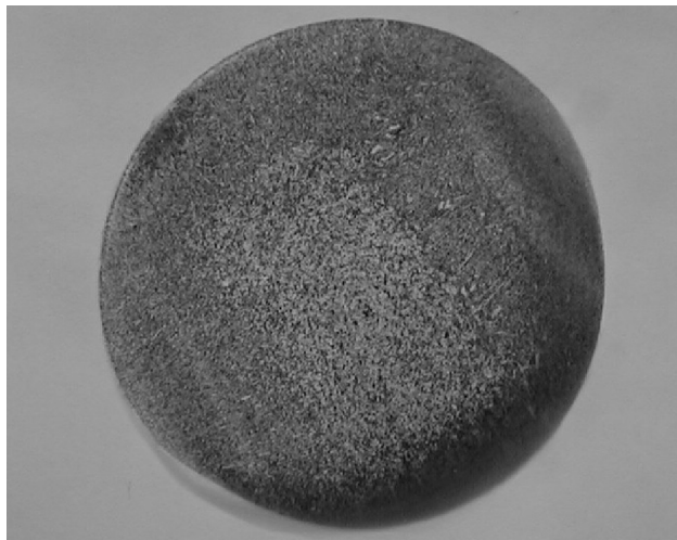
Rys. 6. Rozkład siarki na przekroju poprzecznym śruby – odbitka Baumanna [opracowanie własne]
