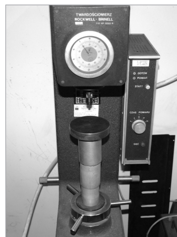
Rys. 3. Widok twardościomierza typu KP15002 P [fot. K. Franczak]
