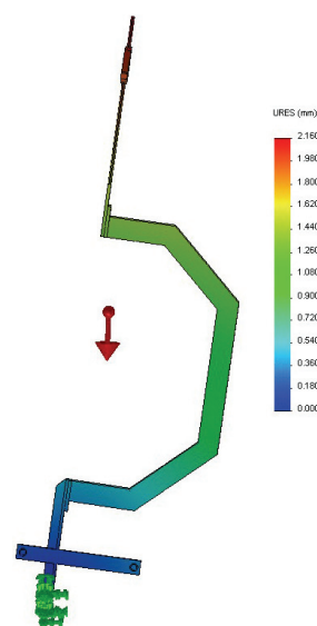
Rys. 16. Wyniki uzyskane z symulacji przemieszczeń poszczególnych punktów elementów przyrządu zamocowanego na końcu przyrządu pomiarowego od strony przeciwnej do zespołu pomiarowego pionowo zespołem pomiarowym do góry, wariant B przekroju kabłąka [opracowanie własne]
