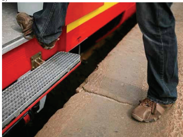
Rys. 20. Przesłona luki [39]: a) wysuwana, b) obracana
