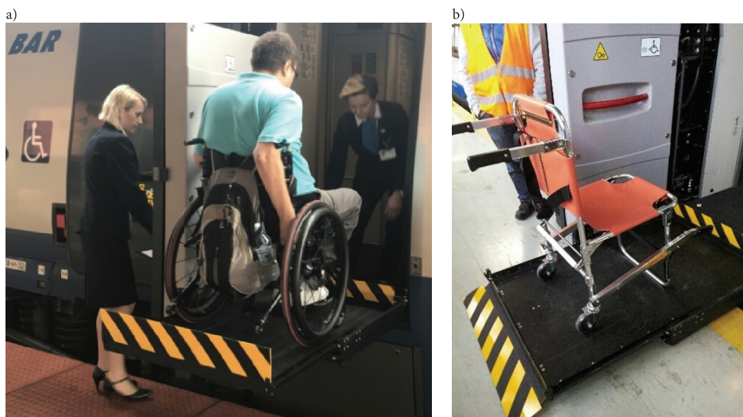
Rys. 16. Podnośnik montowany przy drzwiach wagonu: a) podczas podnoszenia podróżnego na wózku inwalidzkim [22], b) krzesło na podnośniku dla osób o ograniczonych możliwościach ruchowych, nie poruszających się na wózkach inwalidzkich [23]
