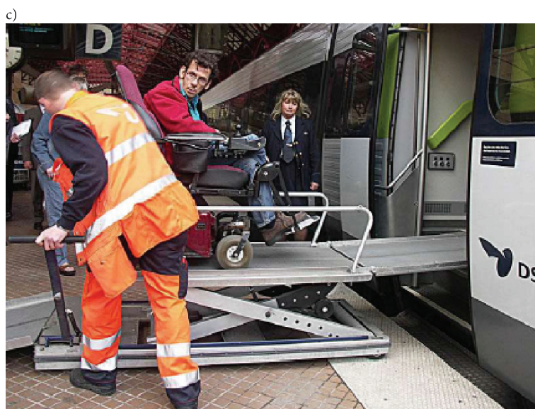
Rys. 14. Zastosowanie podnośnika peronowego: a) koleje szwajcarskie [5], b) koleje niemieckie [21], c) koleje duńskie [6]
