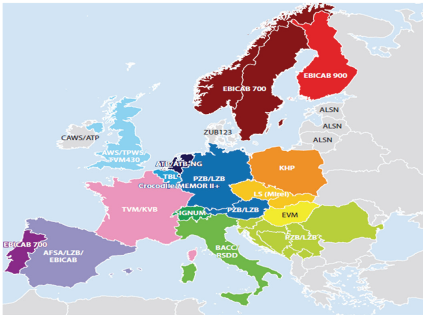
Rys. 4. Różne systemy zabezpieczenia sieci kolejowej w Europie [6]
