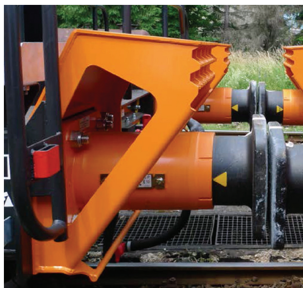
Rys. 4. Moduł antywspinaniowy EST AC04 oraz odkształcalny zderzak pochłaniający energię zderzenia EST G2 [6]
