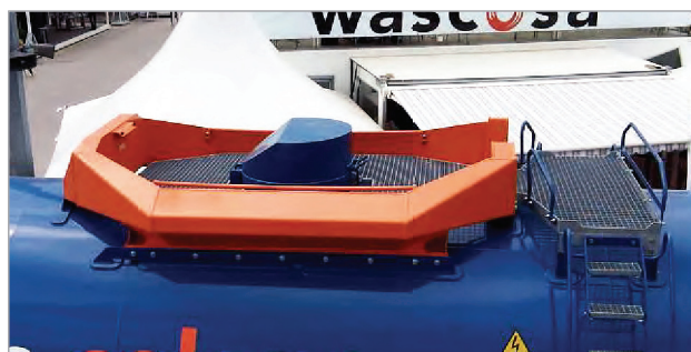
Rys. 7. Moduł o oznaczeniu UE01 zabezpieczający zawory zbiornika przy przewróceniu [1]
