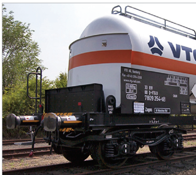
Rys. 5. Czołowa osłona ochronna zbiornika oraz uchwyt usprawniający działania ratunkowe [5]
