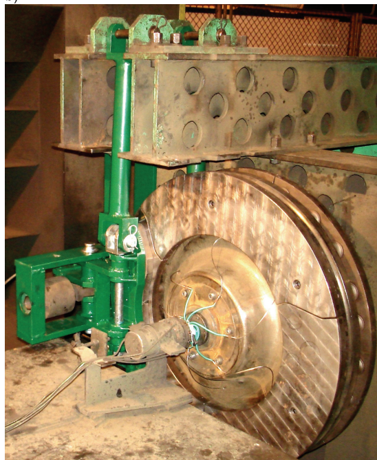
Rys. 18a), b) Widok tarczy hamulcowej na stanowisku hamulcowym z mechanizmem dźwigniowym [fot. W. Sawczuk]
