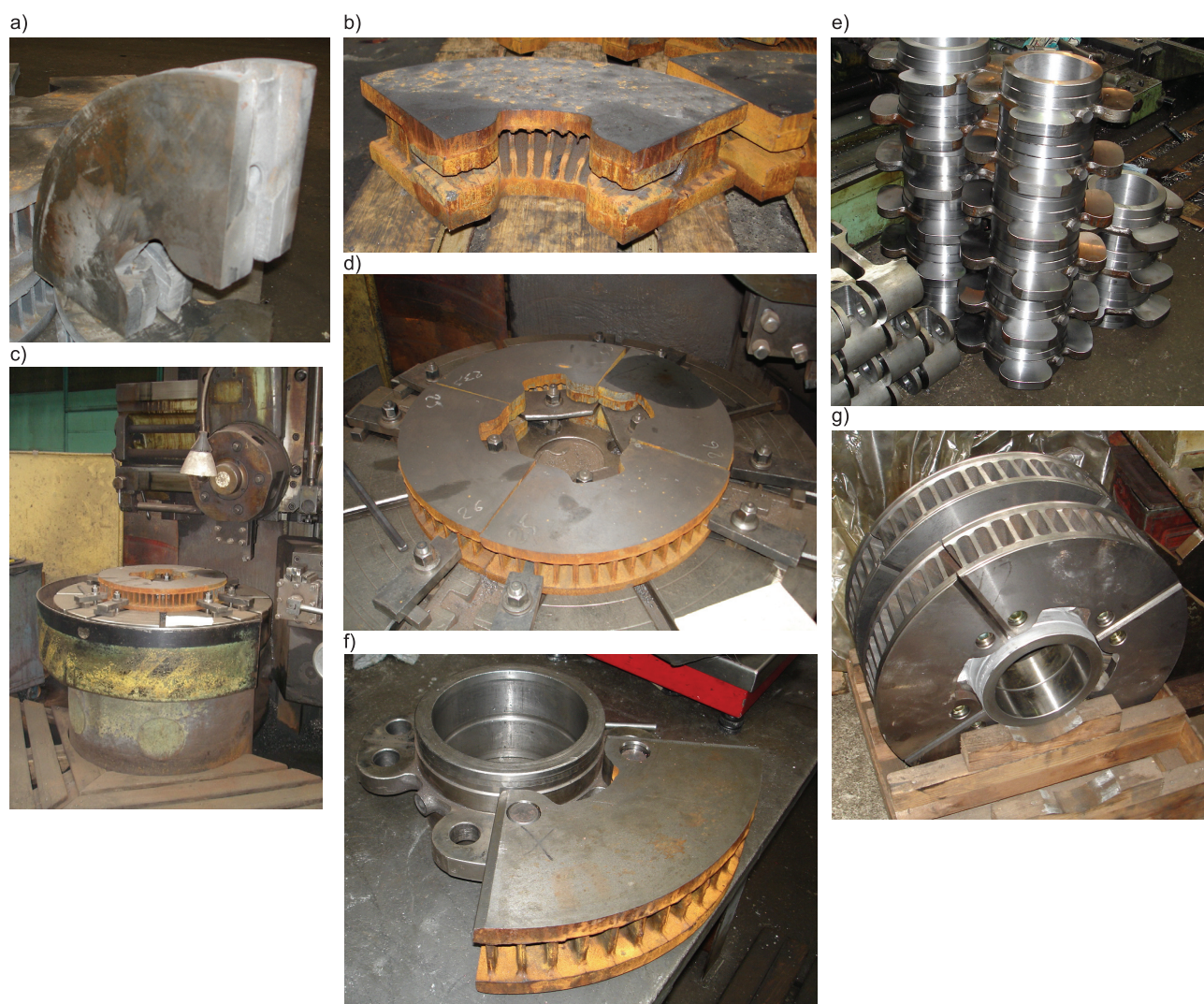
Rys. 4. Wybrane etapy z produkcji segmentowej tarczy hamulcowej BK 141 mocowanej na osi zestawu kołowego: a), b) odlewy segmentów tarczy dzielonej przed obróbką skrawaniem, c) segmenty tarczy zamocowane na tokarce karuzelowej, d) segmenty na stole tokarki karuzelowej ze wstępnie obrobioną powierzchnią cierną, e) piasta hamulcowa z obrobionymi powierzchniami przed wierceniem otworów montażowych, f) montaż segmentów do piasty hamulcowej za pomocą sworzní, g) zmontowane dwie tarcze hamulcowe [fot. W. Sawczuk]
