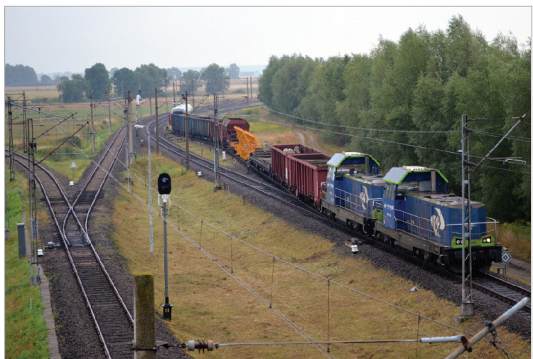
Rys. 5. Skład pomiarowy do badań na łukach odrotnych [fot. autorzy]
