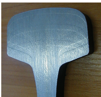
Rys. 3. Przekrój poprzeczny główki szyny po cięciu na pile [fot. autorów]
