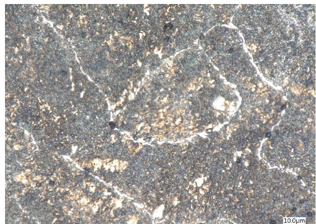
Rys. 16. Linia zgrzewania złącza szynowego z gatunku R350HT po badaniach zmęczeniowych [fot. autorów]
