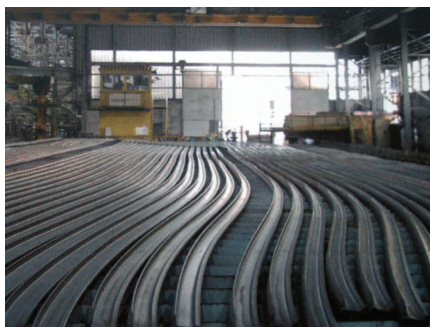
Rys. 1. Chłodzenie szyn po walcowaniu na rusztach chłodni [fot. autorów]
