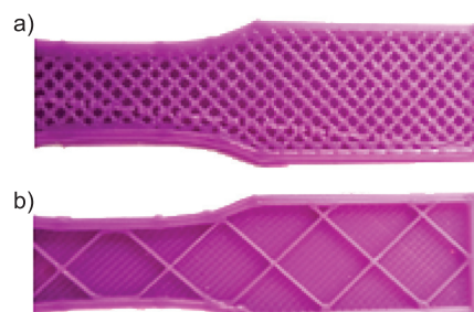
Rys. 4. Przekrój poprzeczny próbek z polilaktydu do próby rozciągania: a) z gęstością druku 50%, b) z gęstością druku 10%
