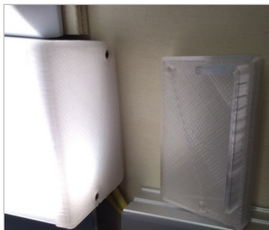
Rys. 1. Zaślepki z tworzywa sztucznego do oświetlenia LED w pojazdach kolejowych [fot. Horvath HEH-LED]
