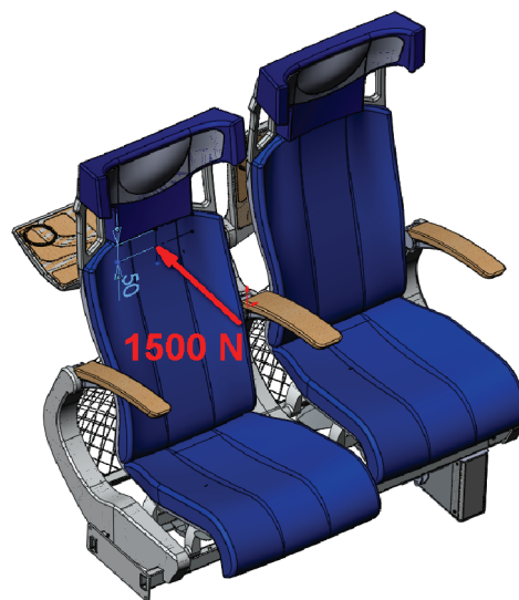
Rys. 4. Punkt przyłożenia siły podczas testu wytrzymałości (50 mm poniżej górnej granicy oparcia) [opracowanie autorów]
