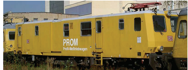
Rys. 5. Pojazd pomiarowy ograniczeń skrajniowych PROM (oznaczony jako 712 002) [fot. Erik Rauner]
