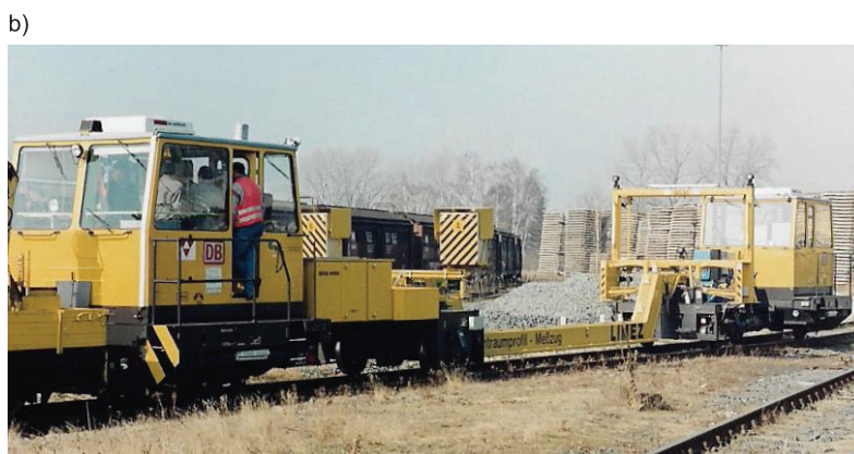
Rys. 7. Pojazd pomiarowy LIMEZ I: a) widok ramy z przyrządami pomiarowymi, b) widok pojazdu [fot. ze zbioru autora]
