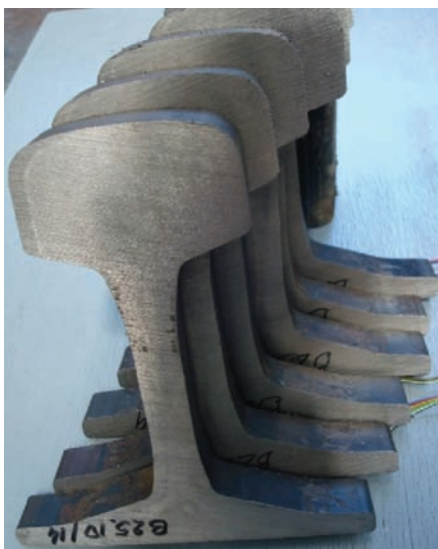
Rys. 4. Szyny z uwolnionymi naprężeniami [fot. autorzy]
