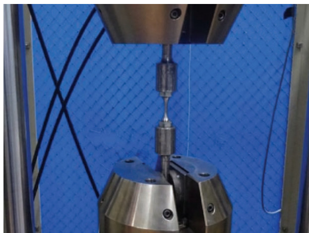
Rys. 5. Badanie zmęczeniowe próbki szyn [fot. autorzy]
