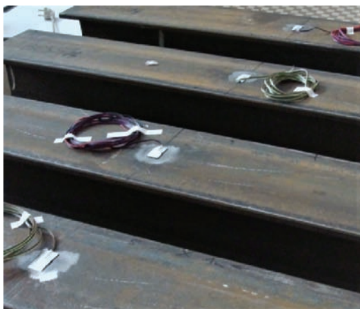
Rys. 3. Szyna z umieszczonymi tensometrami [fot. autorzy]
