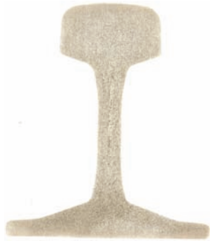
Rys. 6. Odbitka próby Baumana szyny oceniona na wzorec D2 [fot. autorzy]
