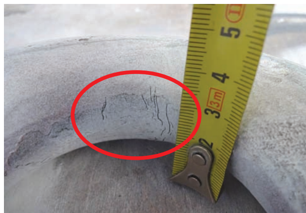
Rys. 4. Pęknięcia pałaka śrubowego 1 MN po badaniach zmęczeniowych metodą magnetyczno-proszkową [fot. D. Kowalczyk]
