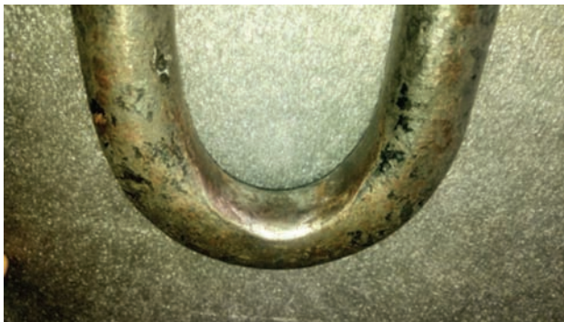
Rys. 1. Widok zużytej (w warunkach rzeczywistej eksploatacji) powierzchni pałaka sprzęgu spowodowany ścieraniem o hak ciągowy [fot. A. Aniszewicz]
