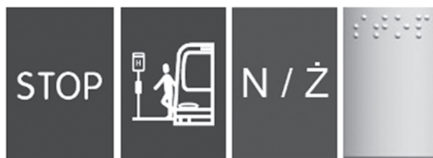
Rys. 3. Przykładowe informacje wizualne i dotykowe umieszczone na przycisku; opracowanie własne na podstawie [2]
