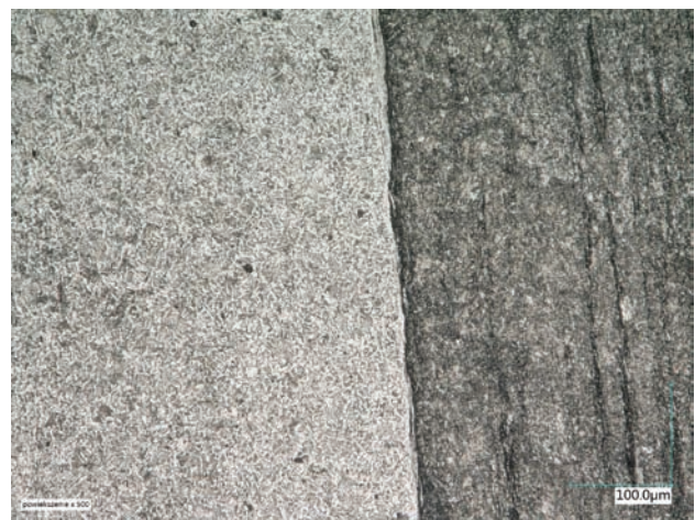
Rys. 6. Mikrostruktura złącza zgrzewanego różnoimiennej pomiędzy stalą B500B i 1.4021; po lewej stronie mikrostruktura stali zbrojeniowej B500B, po prawej struktura stali martenzytycznej z wyraźną włóknistością; mikrostruktura w stanie wyjściowym przed rozciąganiem [fot. M. Ostromęcka]
