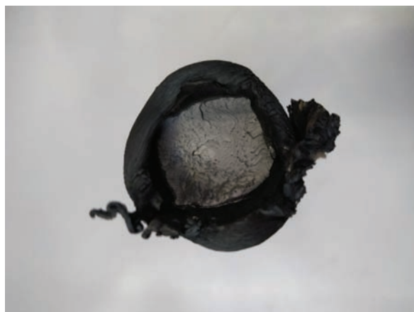
Rys. 8. Przekrój w zgrzeinie w próbce B22.5/21 [fot. M. Ostromęcka]
