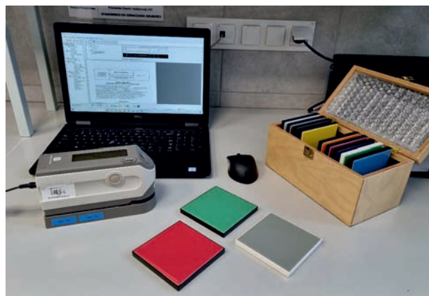
Rys. 3. Stanowisko badawcze do określania barwy według PN-EN ISO 7724-2 [22]; spektrofotometr Konica Minolta CM2600D, standardy spektrofotometryczne CCSII Lucideon Ltd; [fot. M. Garbacz]
