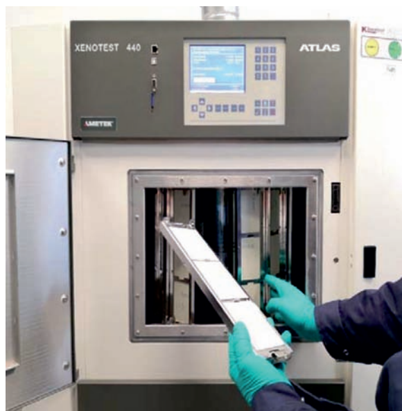
Rys. 2. Stanowisko badawcze do starzenia próbek według PN-EN 16474-2 [11]; komora świetlna, Atlas GmbH Xenotest 440; [fot. M. Garbacz]
