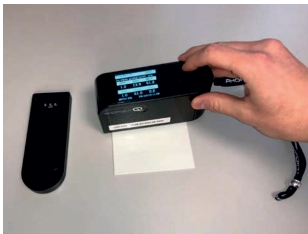
Rys. 4. Stanowisko badawcze do określania połysku według PN-EN ISO 2813 [24]; połyskomierz Rhopoint IQ-S; [fot. M. Garbacz]
