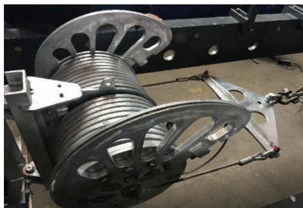
Rys. 2. Sprężynowe urządzenie naprężające [fot. P. Kwaśniewski]
