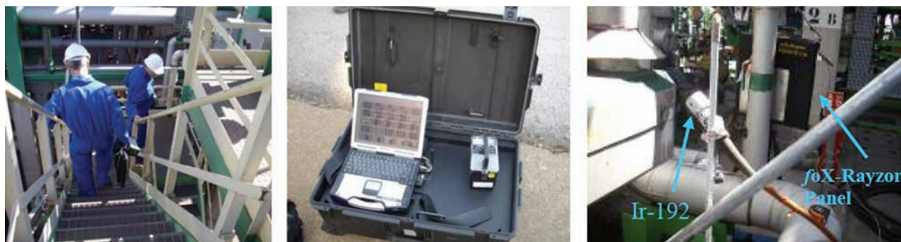
Rys. 5. Praca w rafinerii z przenośnym systemem do radiografii cyfrowej DR [45]
