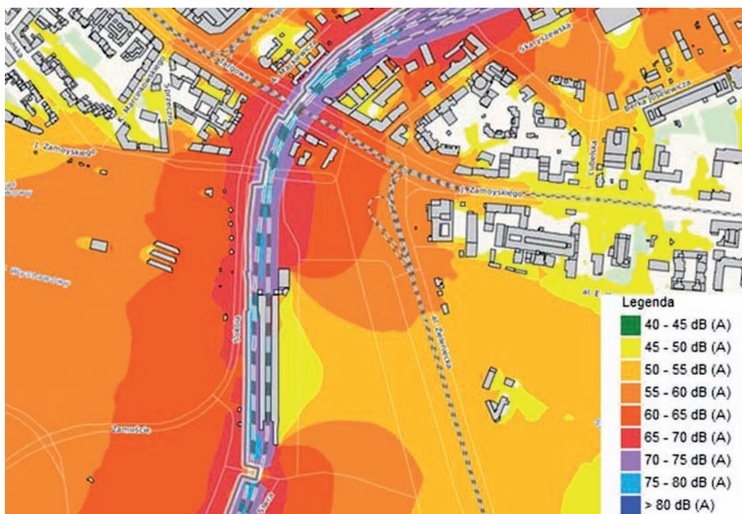
Rys. 2. Przykładowa mapa linii kolejowej wraz z rozkładem poziomu hałasu (izolinie) [49]
