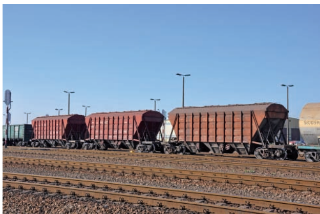
Rys. 26. Wagony UZ (1520 mm) do przewozu zboża serii 19-752 na stacji Hrubieszów LHS (25.10.2014 r.) [fot. M. Graff]
