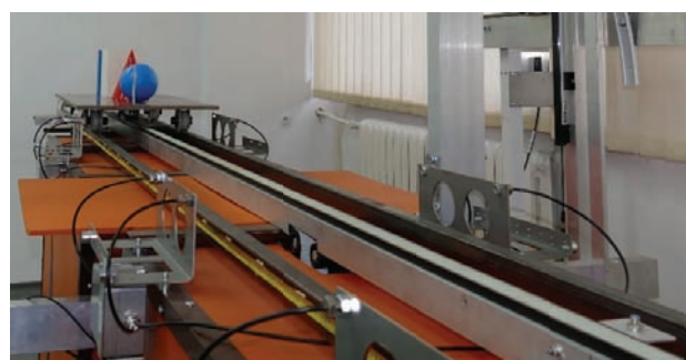
Rys. 1. Prostoliniowy tor pomiarowy z ruchomą płaszczyzną badawczą [fot. J. Moczarski]
