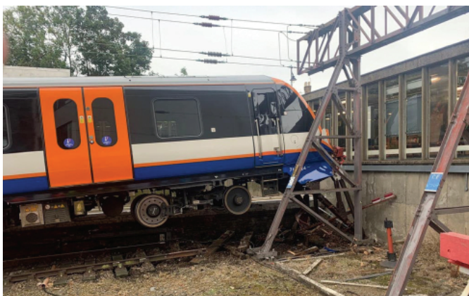
Rys. 20. Wykolejenie pociągu (12.10.2021 r.) w Londynie na Enfield Town – najazd na stały kozioł oporowy ( buffer stop ) [9]
