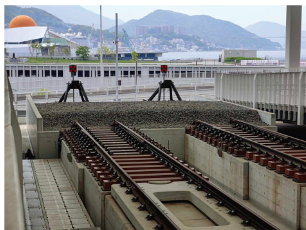
Rys. 9. Urządzenie zakończenia torów – stałe (nieprzesuwne) na stacji Nagasaki, Japonia [fot. M. Peryt]
