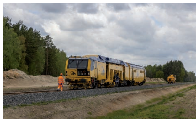
Fig. 26. Tamping machine on the Jastrząbka – Parciaki route on LK 35 [photo by Ł. Bryłowski / PLK]
