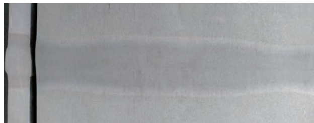
Rys. 3. Makrostruktura złącza ze stali R260 [opracowanie własne]
