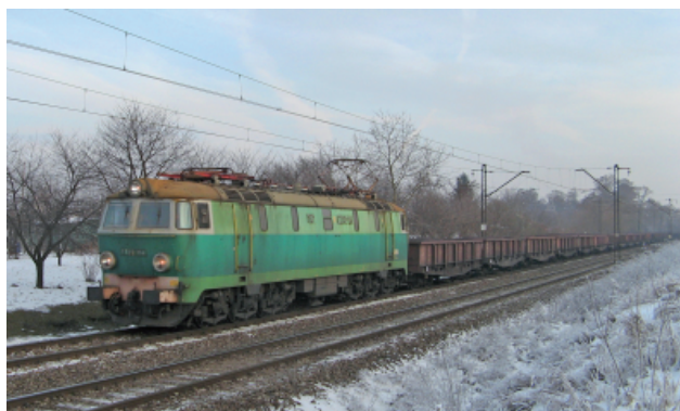
Rys. 11. ET22-114 z wagonami typu Eaos z rudą żelaza na odcinku Munina – Jarosław na LK 91 (24.12.2007 r.) [fot. M. Graff]
