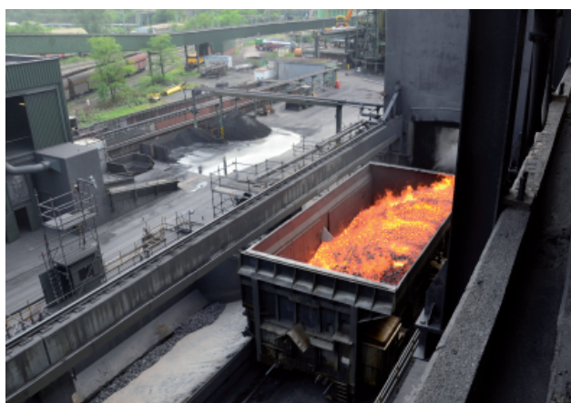
Rys. 10. Schładzanie rozżarzonego koksu na terenie koksowni Prosper w Bottrop, land Nadrenia Północna-Westfalia, Niemcy (26.04.2011 r.) [fot. NatiSythen / Wikimedia Commons]
