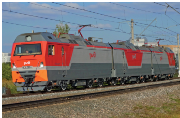
Rys. 3. 2ES10-139 (3 kV DC) podczas targów Ekspo 1520 na torze doświadczalnym WNIIZT w Szczerbinie pod Moskwą (31.08.2017 r.) [fot. Self-photographed / Wikimedia Commons]
