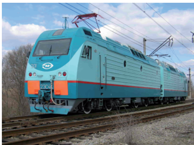
Rys. 12. 2ES4K-001 (3 kV DC) (2005 r.) [fot. Transmaszholding / Wikimedia Commons]
