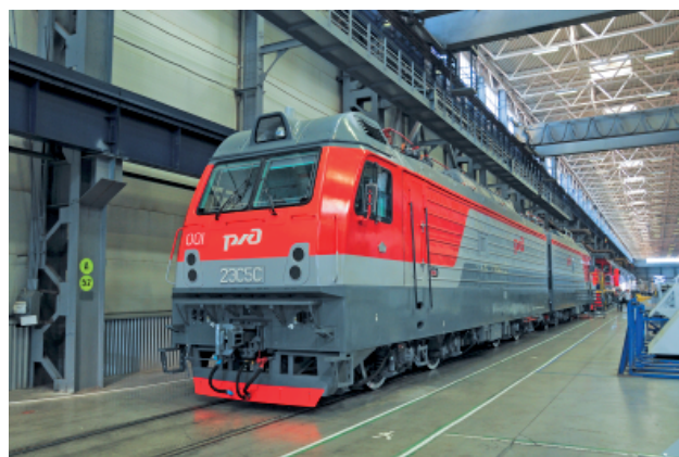
Rys. 11. 2ES5S-001 (25 kV 50 Hz) na terenie Brińskiej Fabryki Maszyn podczas prezentacji (26.06.2018 r.) [fot. Transmaszholding / Wikimedia Commons]
