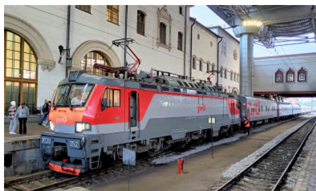
Rys. 2. Dwusystemowa EP20-052 (napięcie w sieci – 3 kV DC) z pociągiem pasażerskim na Dworcu Kazańskim, Moskwa (27.10.2024 r.) [fot. ze zbiorów autora]
