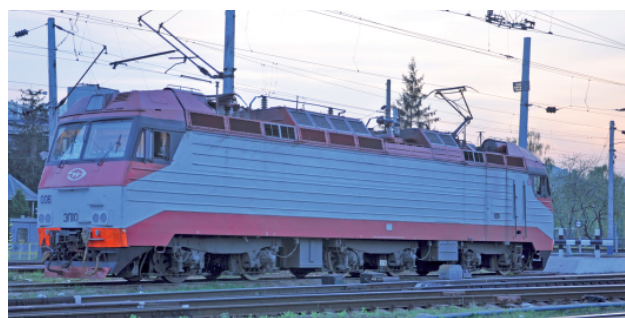
Rys. 1. Dwusystemowa EP10-006 (napięcie w sieci – 25 kV 50 Hz) na stacji Kijów (30.04.2013 r.) [fot. M. Graff]
